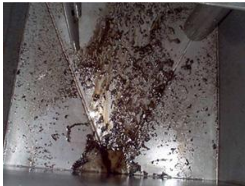
Резервуар гидравлической системы перед процедурой очистки
