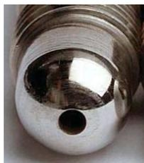
Износ образцов, загрязненных сажей, в окисленных условиях – 2 среднестатистических испытания. Процедура аналогична SAE 2002-01-2793, испытательная аппаратура из ASTM D975
